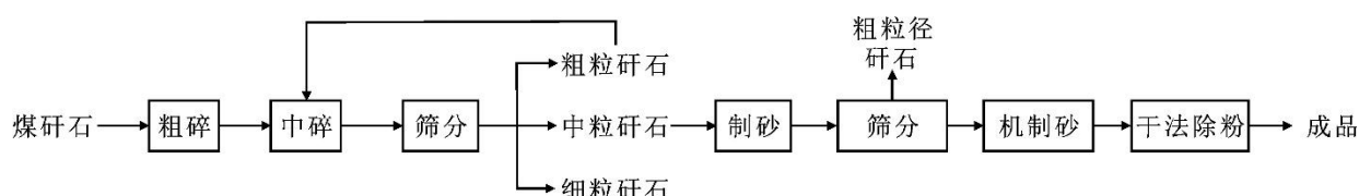
图 6.8.1-1 煤矸石机制砂制作流程
