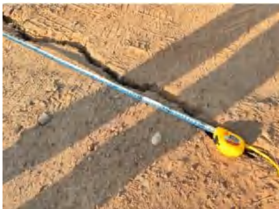
照片3-1 拉张裂缝（镜向W）
