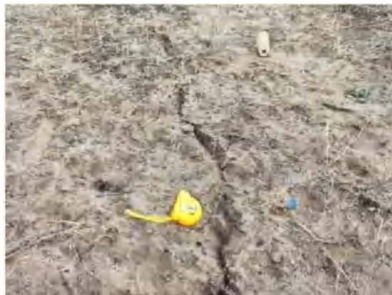
照片3-2 拉张裂缝（镜向E）
