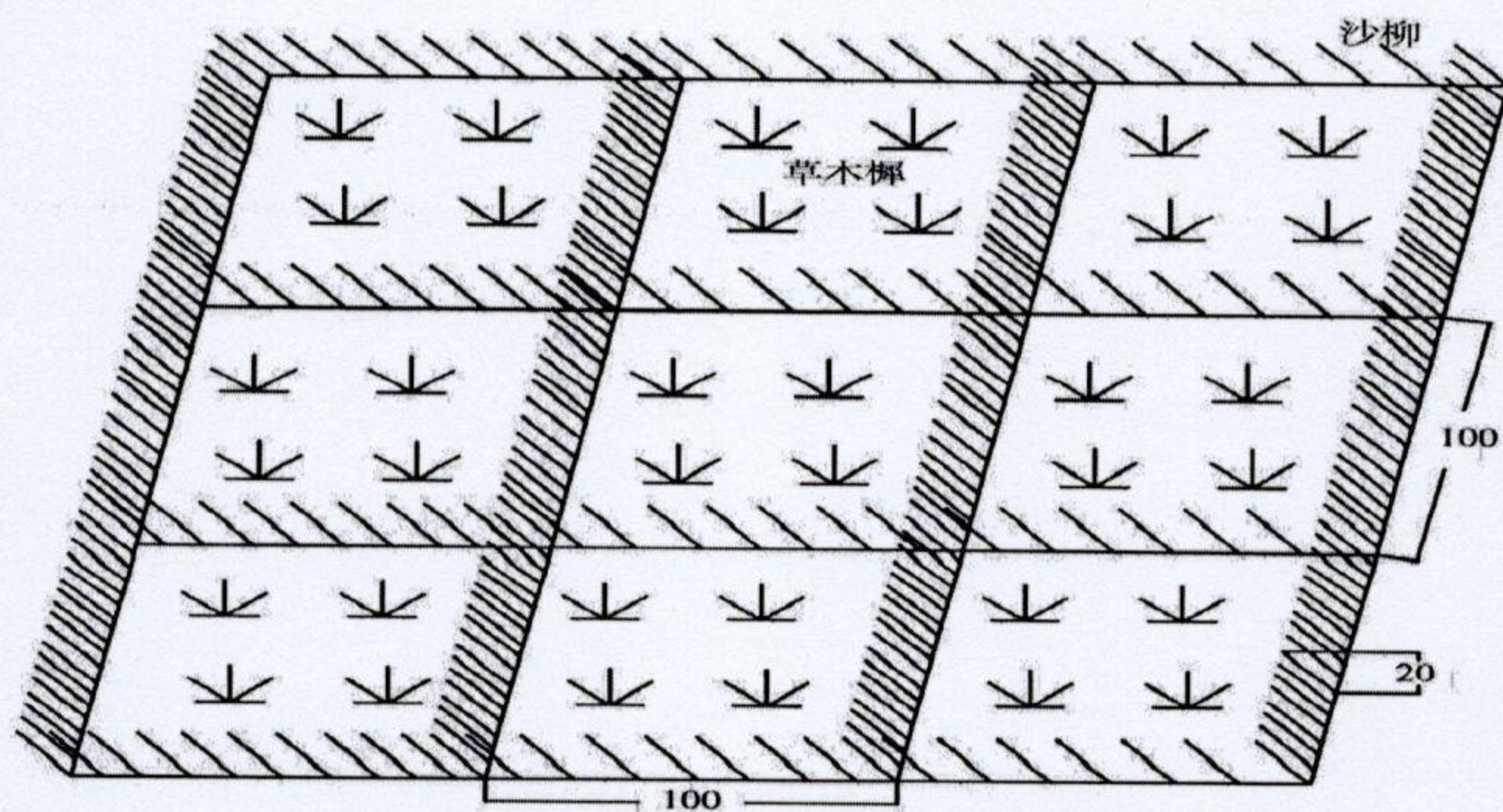
图 5-3 沙柳沙障示意图
